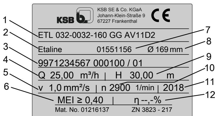
Rys. 4: Tabliczka znamionowa (przykład)
